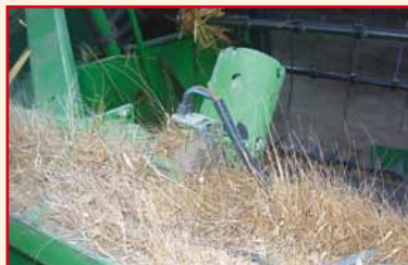
Figuur 43: Maaibek van een maaidorser zonder beschermkappen
