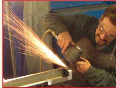
Figuur 35: Een slijpschijf die schuurt over een metalen oppervlak produceert gensters (links) Lasdoeken ophangen in een werkplaats zorgt voor afscherming (rechts)
