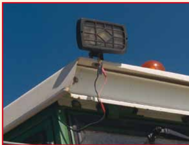
Figuur 19: Een gebrekkige kabel op een tractor (links) of een kabel in een plas water (rechts) kan leiden tot kortsluiting
